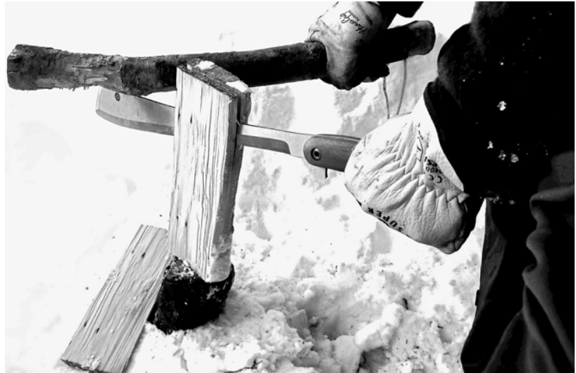
Schindelherstellung durch Batoning mit dem Parang
