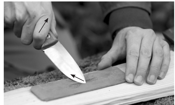
3. Schritt: Ziehbewegung beim Messerschärfen
