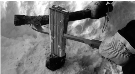
Schindelherstellung mit dem Parang
