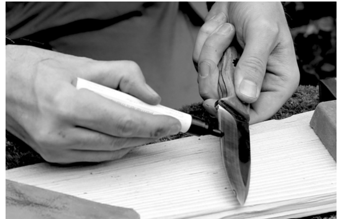
2. Schritt: Die Schneide erhält eine Kontrolllinie
