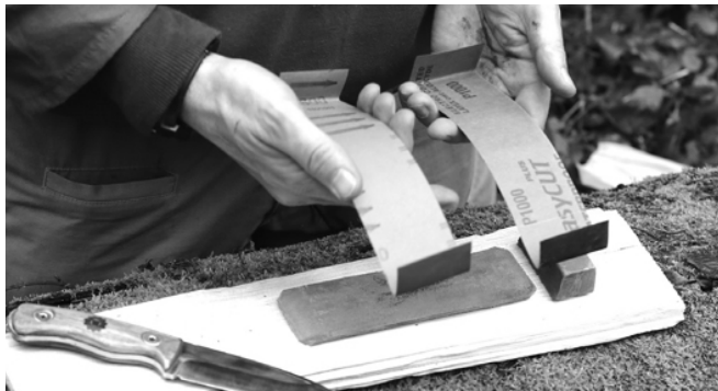
Schleifpapierstreifen zur Entfernung von Ausbrüchen
