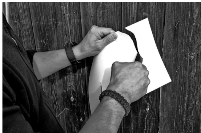
4. Schritt: Schärfe der Klinge mit Papierschnitt prüfen
